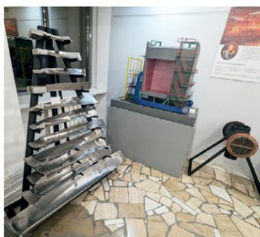
Стенд с лопатками паровой турбины (на фото слева)
